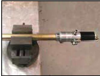
2. Aperte um tubo roscado macho de 1/2" no adaptador de saída (35) e desaparafuse o conjunto do motor pneumático no sentido anti-horário.
