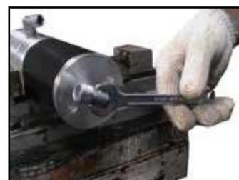
14. Bata levemente no Cilindro (10) com um martelo de plástico e desaparafuse-o.
