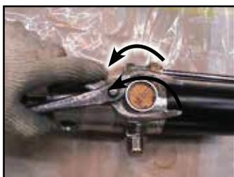
11. Segure o conjunto do motor pneumático em um torno de garra macia. Solte as duas porcas de acoplamento (2) usando uma chave inglesa (tamanho 21 mm).
