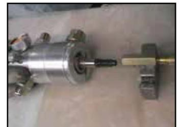
7. Segure o tambor (55) em um torno de garra macia. Conecte uma chave de gancho C ajustável (tamanho 1-1/4" a 3") ao orifício da lingueta e desaparafuse o acoplador (44) no sentido anti-horário.
