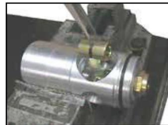
22. Abra os dois parafusos (29) com uma chave de fenda Philips e remova o clipe (28).
