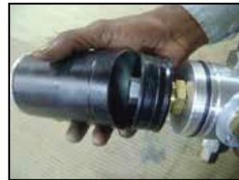
15. Desaparafuse o adaptador da tampa de entrada (34) usando uma chave inglesa (tamanho 25 mm).
