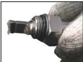
19. Usando duas chaves (tamanho 10 mm), segure a haste do êmbolo (9) e gire a biela (43) no sentido anti-horário. Isso desaparafusará a biela (43).
