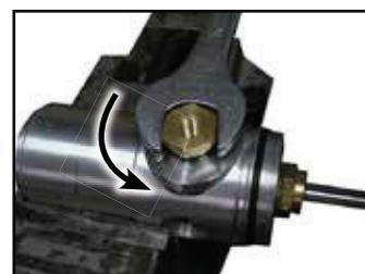
16. Conecte uma chave de pinça nos orifícios da tampa de entrada (32) e desaparafuse no sentido anti-horário.
