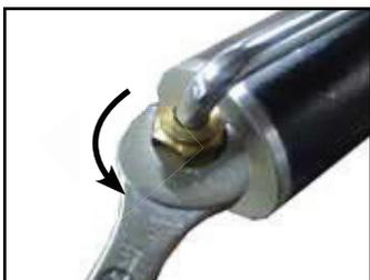
12. Remova o tubo dobrável (1) junto com as porcas de acoplamento (2) e os anéis de vedação (3).
