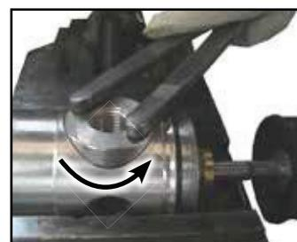
17. Desaparafuse os dois empurradores (15) usando uma chave inglesa (tamanho 25 mm).
