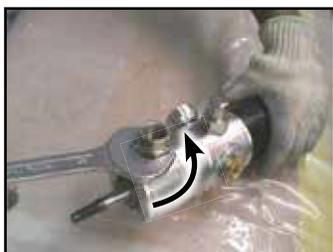
10. Desaparafuse a válvula de escape (23) com um alicate de mandíbula largo
